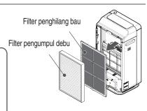
Lepaskan kemasan plastik dari filter yang baru, dan pasang filter di alat
