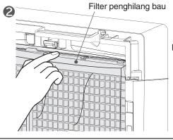
Filter penghilang bau
