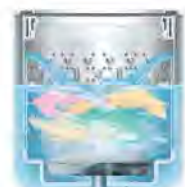
Air pada level ketiga akan membuat deterjen sampai ke permukaan kain.
