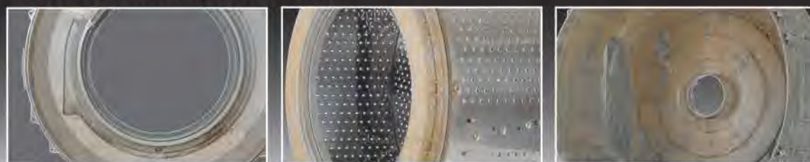
Kotoran di belakang bagian luar tabung pelindung depan
