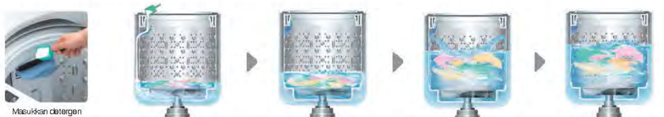
Air pada level terendah akan membuat deterjen di bawah kindir.
